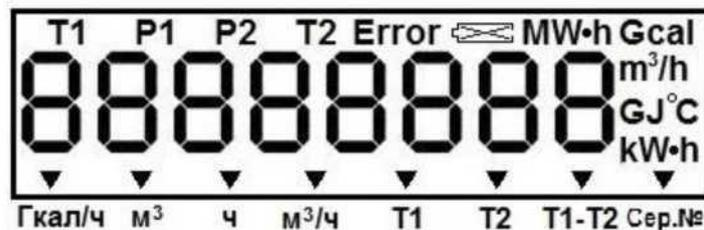
Рисунок 6. Дисплей вычислителя.
